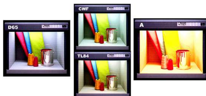
Figura 10.: Uma mesma amostra exposta a diferentes fontes de luz
