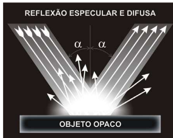
Figura 12.: Reflexão difusa e especular em uma superfície opaca
